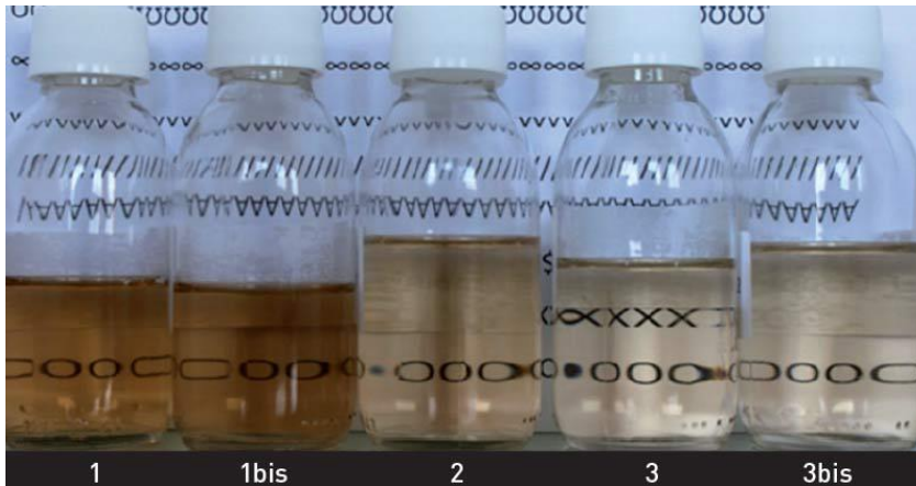
Fig.4: Esempio di asportazione del ferro da parte dei derivati della chitina
