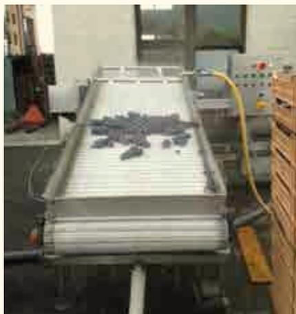
Fig. 2 - Lavatrice manuale a "borbottaggio"
