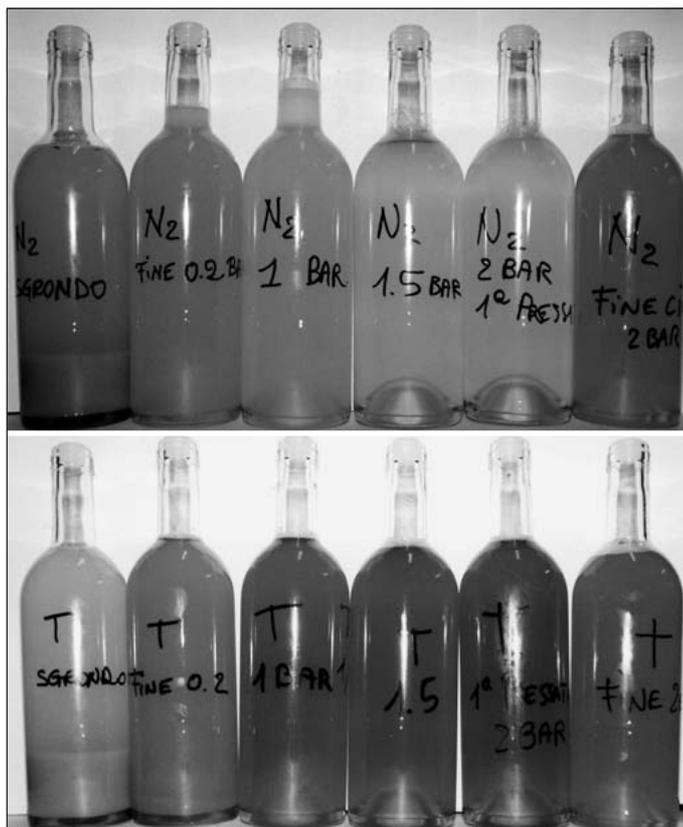
*In alto, pressatura sotto azoto, in basso il testimone*
