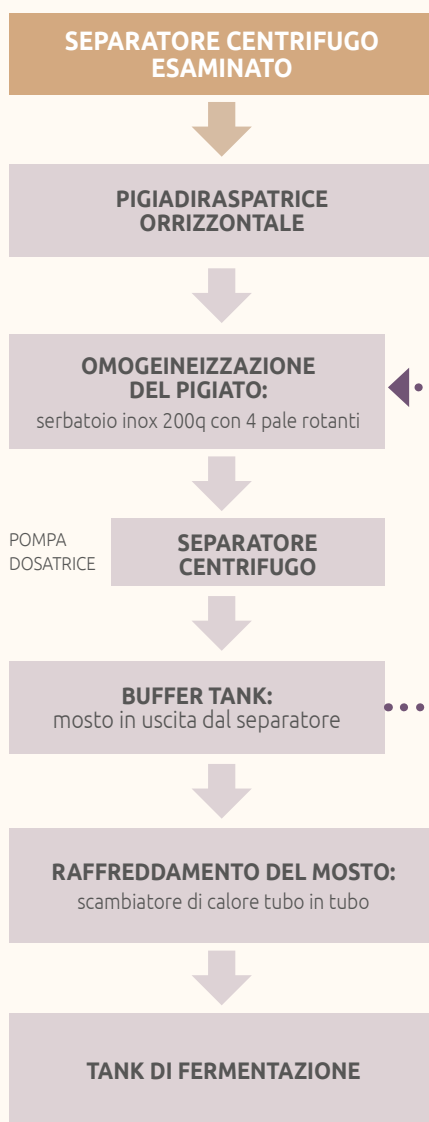
Fig. 2 - Schema di vinificazione in bianco attraverso il processo con separatore centrifugo
