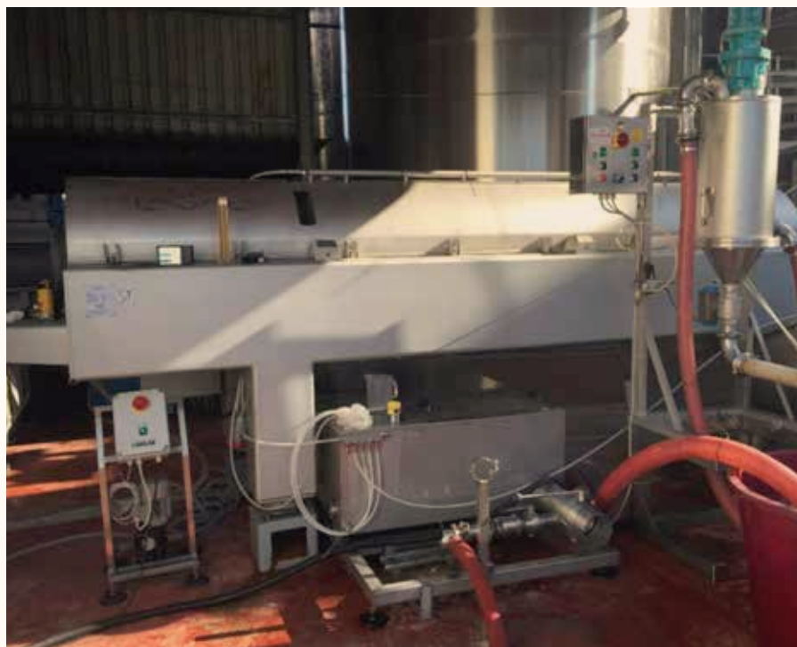
Foto 2 - Centrifuga orizzontale con pompa dosatrice per l'aggiunta proporzionale di specifici coadiuvanti per la buona riuscita del processo
