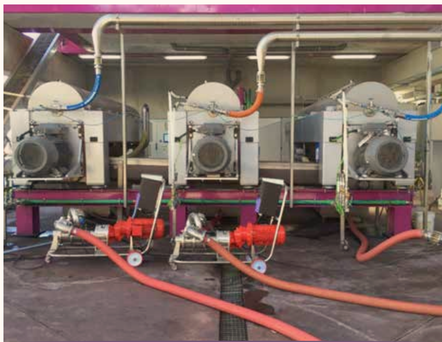
Foto 2 - Centrifuga orizzontale con pompa dosatrice per l'aggiunta proporzionale di specifici coadiuvanti per la buona riuscita del processo
